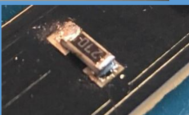
MAL. Falta estaño en la soldadura.
