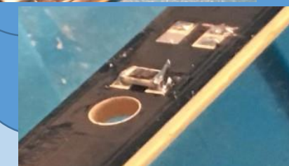
MAL. Hemos retirado muy rápido el soldador.
