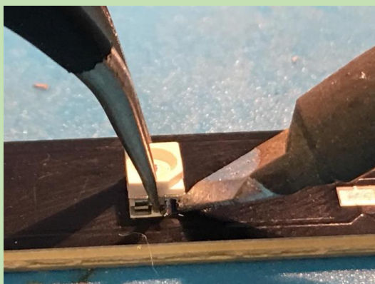
5. Con ayuda de las pinzas ubicamos el componente y con el soldador calentamos el estaño que hemos colocado en el paso anterior y lo fijamos.
